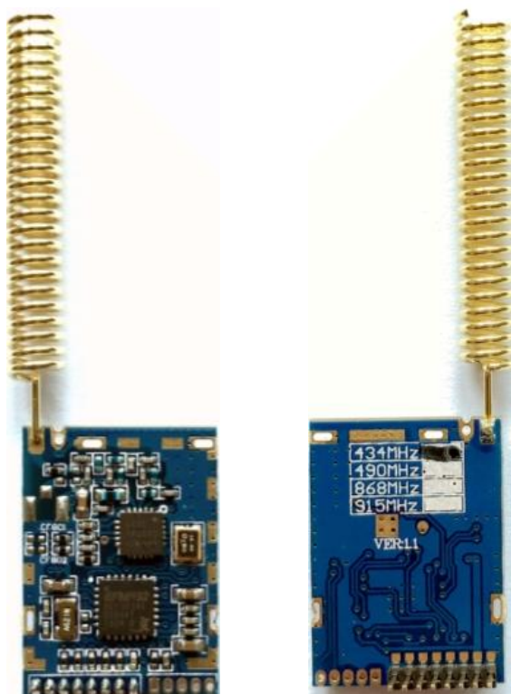
插件型模组（含排针和天线）产品型号后缀-D
